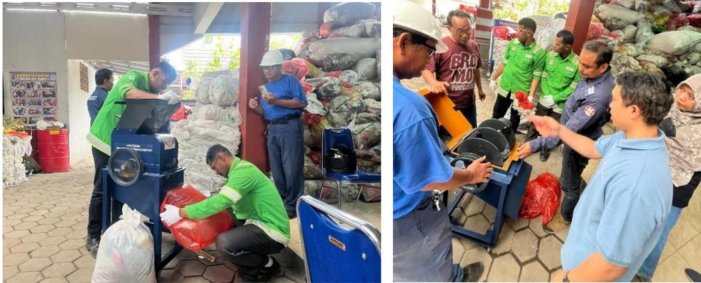
**Gambar 2.** Demonstrasi Pengoperasian Peralatan Pencacah Plastik
